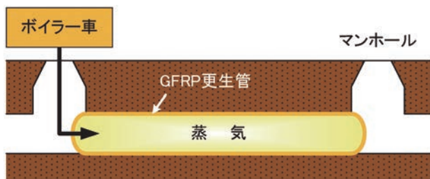
図1 GFRPを用いた管更生工法の模式図
