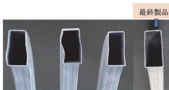
加工条件: R50, A6063-O, 20×10×0.5mm, 積層マンドレルおよび引張り力負荷適用
