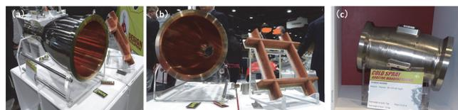
図4 国際溶射会議 ITSC 2018 での Impact Innovations GmbH の CS による造形体の出展の一部：(a) と (b) ロケットモーターのノズル（内面の銅：成膜速度率 10 kg/h, 付着率 99% 以上, 外周面のニッケル：10 kg/h, 97% 以上, 造形総質量 41 kg（加工後の質量：36 kg）, 造形時間 4 時間 10 分）と銅の井形の造形体（6 kg/h, 90% 以上, 造形質量 5 kg, 1 時間）、(c) チタン製の円形造形体（3 kg/h, 97% 以上, 7 kg（加工後の質量：5.5 kg）, 2 時間 25 分）。これらの造形状況は動画で閲覧できる<sup>(5)</sup>
