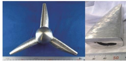
図4 マグネシウム合金を用いたプロペラ形状の造形
