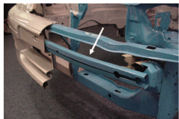
図3 1,200MPa級レインフォースバンパー (ユニプレス(株)提供)
