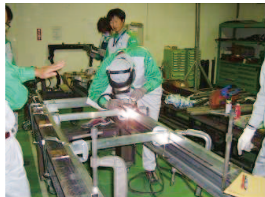
図 3 フレームの溶接
