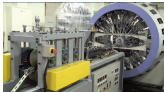
図4 組物強化熱可塑性樹脂複合材料の引抜成形装置
