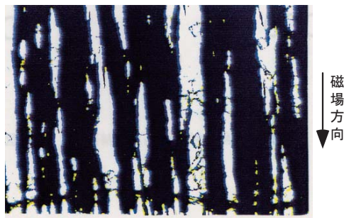
図3 MAGIC 砥石における砥粒分布の様子 (研磨面に垂直方向) 3)
