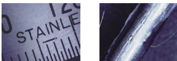
(d)半導体ひずみゲージ (e)出力棒に接着されたゲージ
