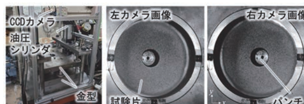
図4 穴広げ成形試験におけるDIC法による非接触ひずみ計測による観測データの取得
