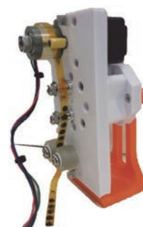
図5 3D プリンタにより試作した放射光回折測定治具
